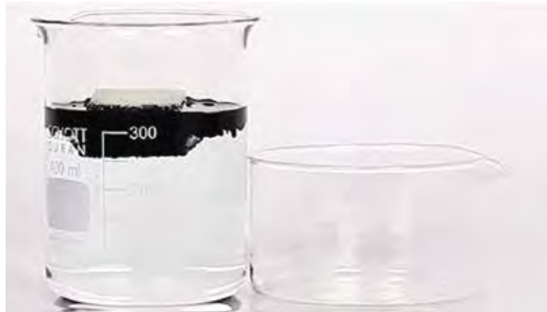
CAMPIONE DI P.U.-F.F. IN FASE DI ASSORBIMENTO DI PETROLIO IN ACQUA
