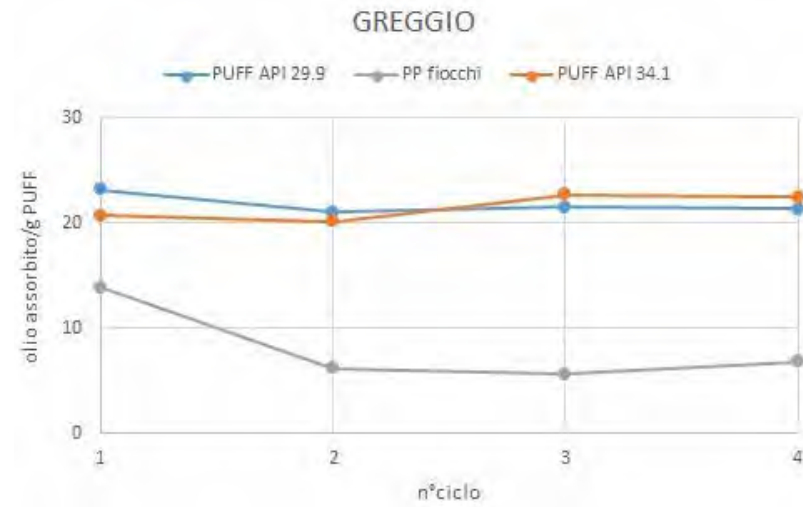
CAPACITÀ ASSORBENTE DI GREGGIO: CONFRONTO TRA P.U.-F.F. E PP IN FIOCCHI (FONTE: RENEWABLE AND ENVIRONMENTAL RESEARCH CENTER, ENI S.P.A)
