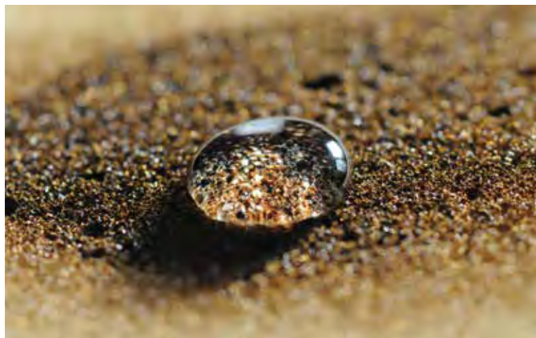
GOCCIA DI ACQUA NON ASSORBITA E PETROLIO ASSORBITO DAL MATERIALE
