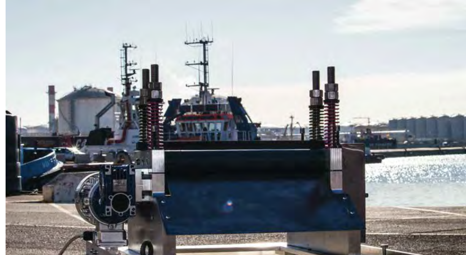
MACCHINARIO PER STRIZZATURA DI P.U.-F.F. DURANTE UNA PROVA PRATICA PRESSO IL PORT DE BARCELONA. CAPACITÀ DI RECUPERO: 120/180 L AL MINUTO
